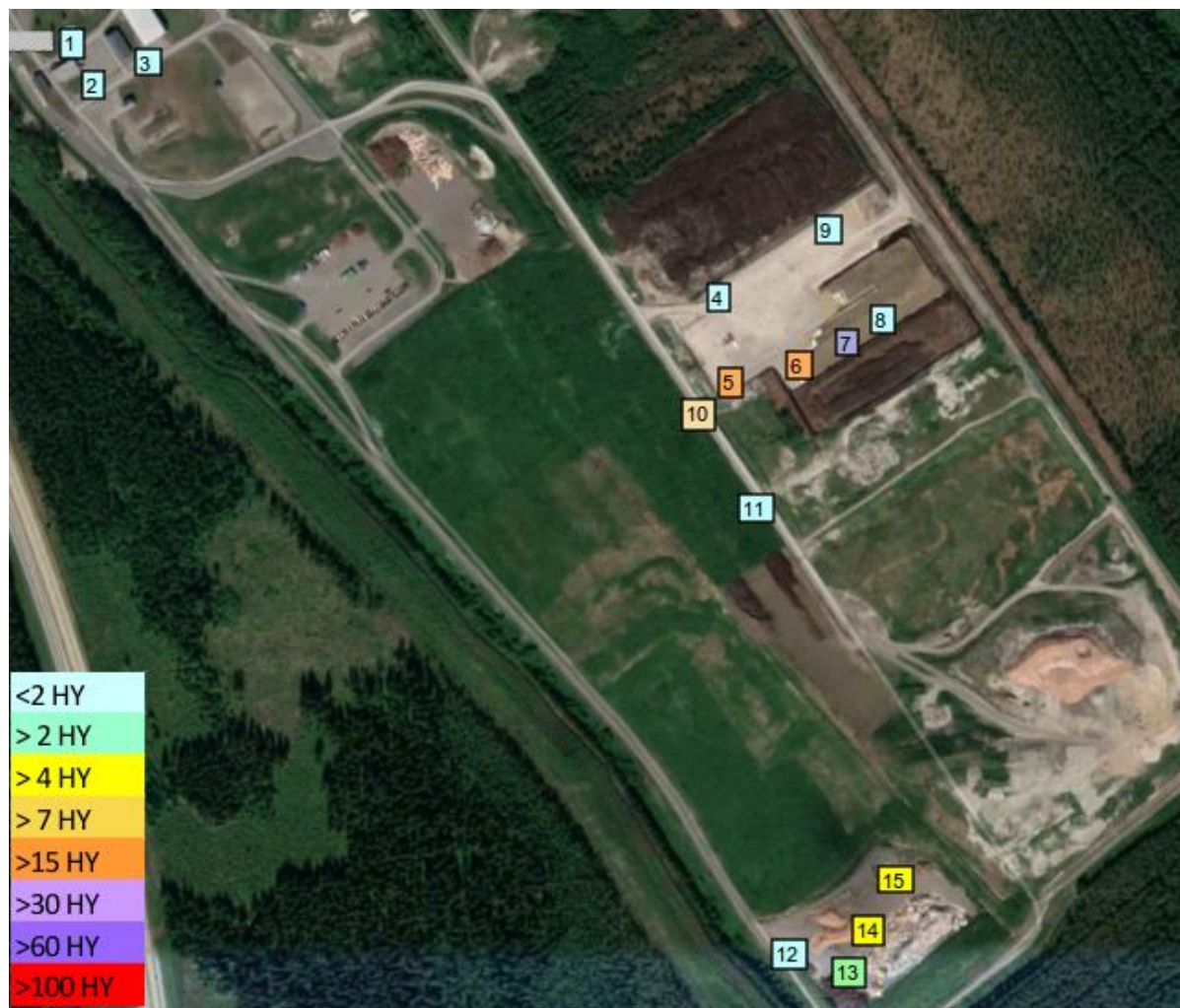
Kuva 7. Kenttäolfaktometri -mittauspisteiden sijainnit, 18.9.2019, Kontiosuon jäteasema. Pisteiden värikoodi esittää korkeinta pisteestä mitattua hajupitoisuutta (kts. Taulukko 4).
